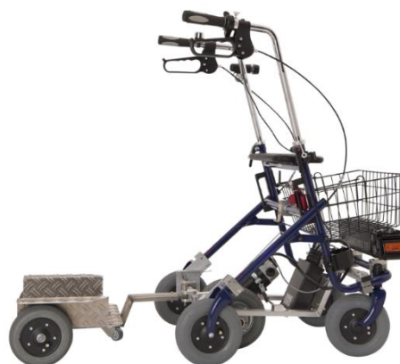
Abbildung 29: Elektrischer Rollator – Aufbau der Firma HB Antriebstechnik
